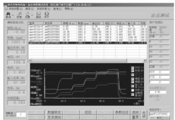
图6 双三相永磁同步电动机测试截图
